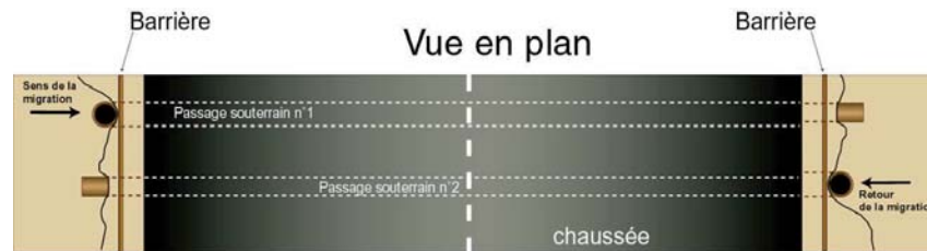
Schéma d'un batrachoduc (vue en plan) Source Ecosphère
