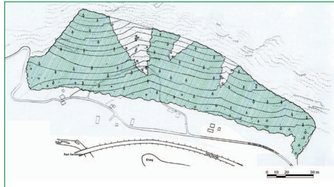
Simulation d'une morphologie similaire à la variante naturelle: volume du modelé paysager autour de 3,5 millions de m 3 . Plantations habillant le modelé paysager et s'attachant à reprendre la couverture actuelle en accord avec la morphologie du versant (Paysage Plus, sept 05)
