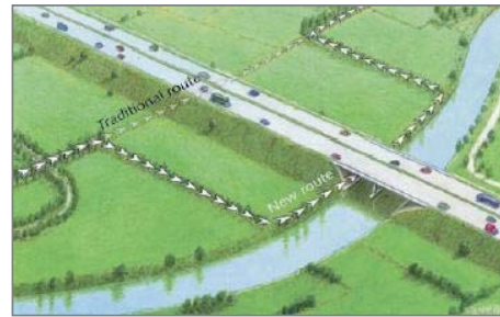
Principe de rétablissement des routes de vols d'après Limpens H.J.G.A., P. Twisk P. & G. Veenbaas, 2005
