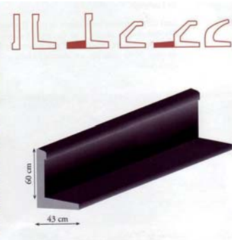
Dalot – batrachoduc à double sens de circulation et différentes formes d'obstacles collecteurs de type cornières préfabriquées (source : Carsignol J., 2005)
